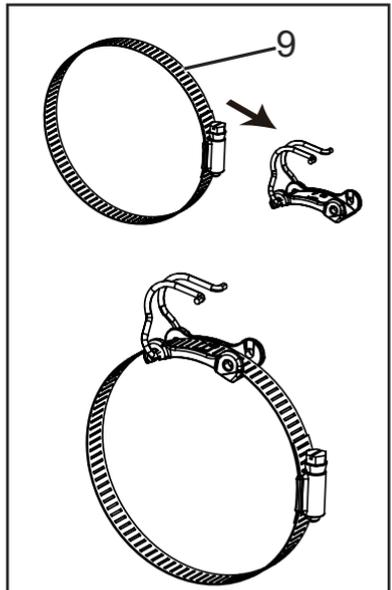
3. Instale las abrazaderas en ambos extremos del tubo flexible (10).
