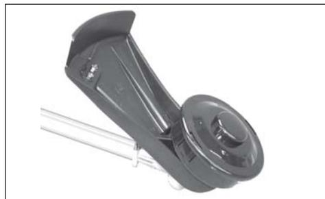
2. Sujete el cabezal de nylon firmemente y empuje hacia adentro las lengüetas de la tapa (A) para quitar el carrete (B) y tapa (C).
