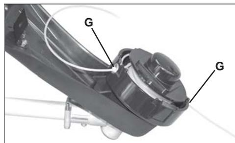
7. Alinee las lengüetas de la tapa con los agujeros de la lengüeta de la caja y empuje hasta que las lengüetas se traben en posición.
