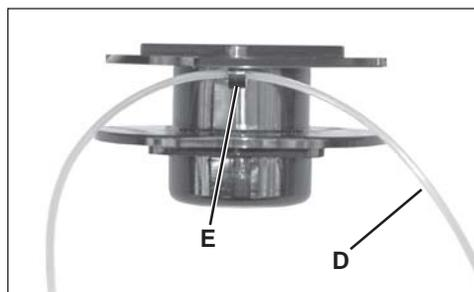
4. Sujete el carrete con la perilla en la mano y la abertura hacia usted. Ponga el dedo índice entre los dos hilos y enrolle el hilo hacia la derecha de forma apretada y uniforme.
