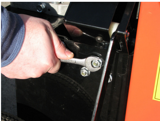
Figura 5.9, Retiro de la protección de la correa
