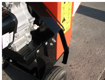
Figura 3.2, Posición de funcionamiento correa acoplado
