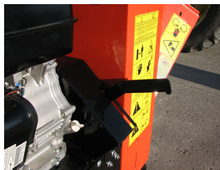
Figura 3.1, Posición de salida correa desacoplado
